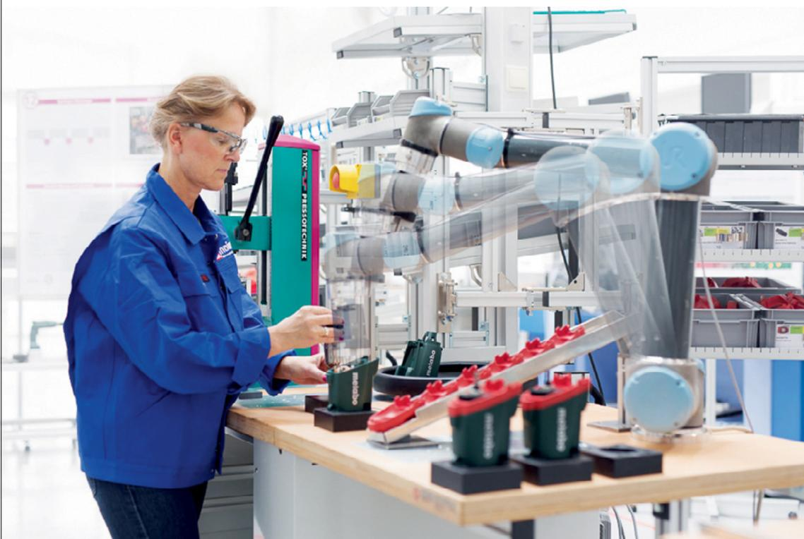
Mensch-Roboter-Kollaboration in der Bohrmaschinenmontage in der Modellfabrik des Fraunhofer IAO in Stuttgart. (Foto: Ludmilla Parsyak) © Fraunhofer IAO
