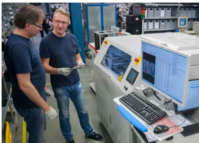
fahren, bei dem u.a. die Richtigkeit von Einpressungen, Bestückungen und Lötstellen punktgenau ermittelt wird. IMM erhöht die Prüfsicherheit seiner Fertigung seit diesem Jahr durch den Einsatz des neuen Flying-Probe-ICT-Testsystems aus dem Hause Takaya.
